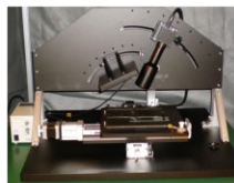
Ca腐食測定装置
