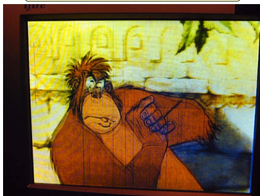
17型SVGAフルカラー, 200cd/m2, パッシブ駆動, セラミック基板使用
