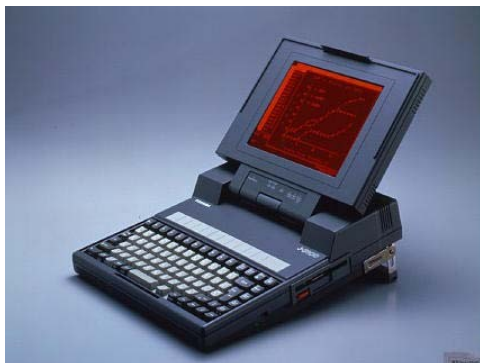
1986年/東芝 世界初ラップトップパソコンT-3100 PDP搭載(640×400ドット)
