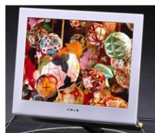
マイクロキャビティ効果を用いた13型アクティブ駆動有機ELディスプレイ試作品(2001年/ソニー)
